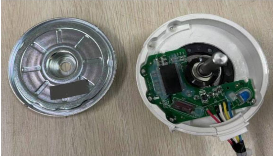
Photo 15 - Unlisted Component Fan Motor ZWR15-A56.
